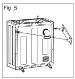
L'échappement ne doit pas se faire dans une cheminée, un mur, un plafond, un grenier, un vide sanitaire ou un espace fermé d'un bâtiment.
